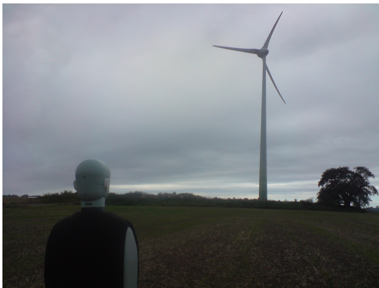
Figur 1: Fotografi från binauralinspelning av ljud från vindkraftverk.
