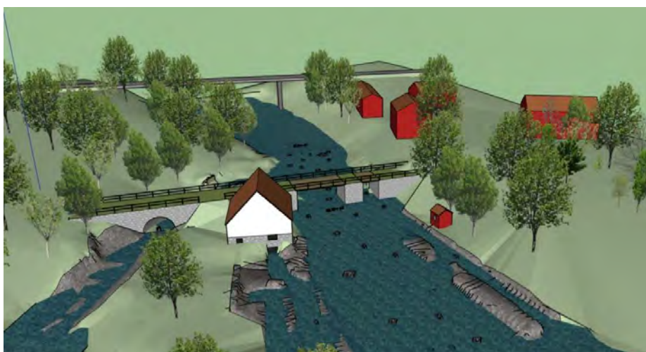
Figur 22. Illustration av stryk kombinerat med en avsänkning vid Järle kvarn. Notera den uppbyggda botten nedanför dammen, och påföljande högre vattenstånd. Norconsult 2014.
