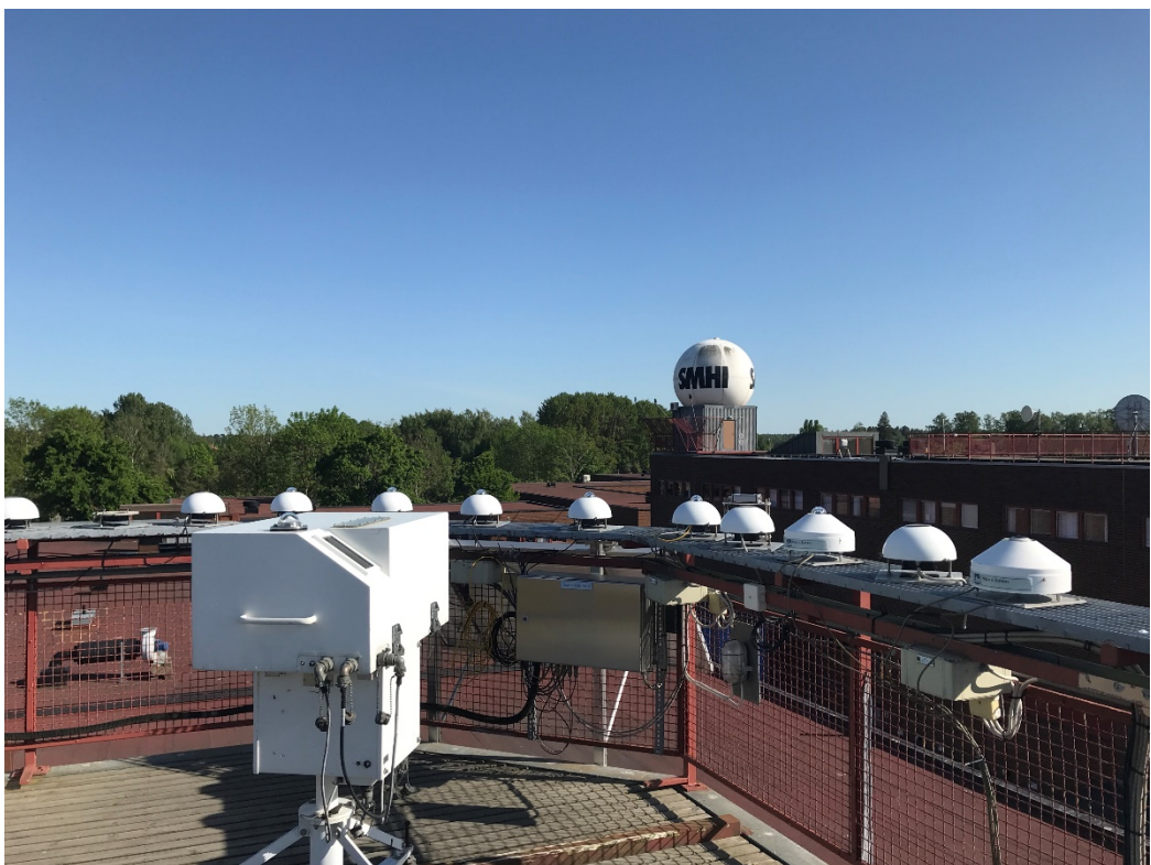
Figur 6.3. Foto från stationen i Norrköping. Ozonspektrofotometern Brewer MkIII No.128 är placerad på ett av SMHI:s tak.
