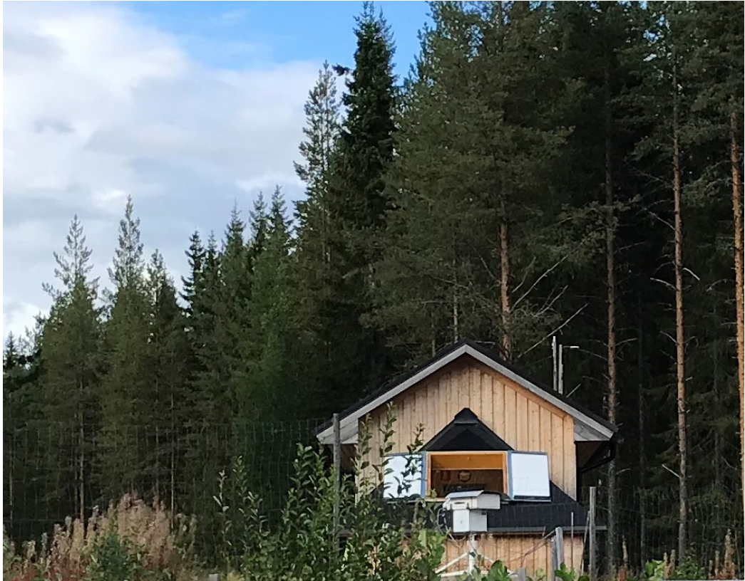
Figur 6.2. Foto från stationen i Vindeln. Ozonspektrofotometern Brewer MkII No. 6 syns framför "ozonstugan" vid SLU:s försökspark Svartberget. Luckorna vid det lägre vinklade taket på ozonstugan är öppna och redo för en mätning med Dobson No. 30.
