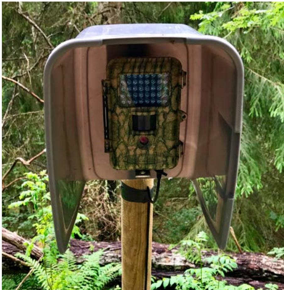
Figur 8. Exempel på kameraskydd tillverkat av plastburk. Notera att skyddet inte har någon botten eftersom det kan samlas snö och annat där som till slut täcker linsen.
