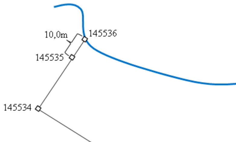
Bild 5. Ett mått har angetts mellan excentrisk gränsmarkering (145535) och inmätt strandlinje, där en ommarkerad gränspunkt konstruerats (145536).
