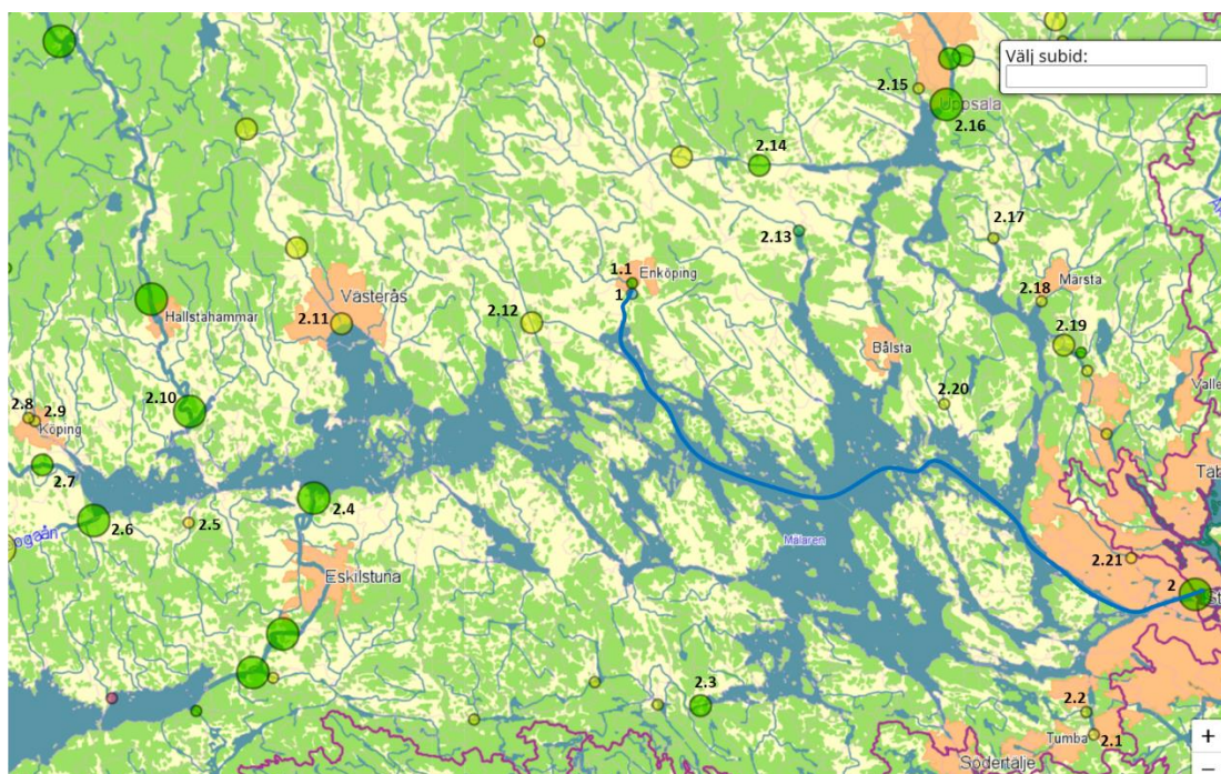
Figur 1. Mätpunkter i den svenska miljöövervakningen som använts för att beräkna kväveretention från Enköpings avloppsreningsverk till havet.
