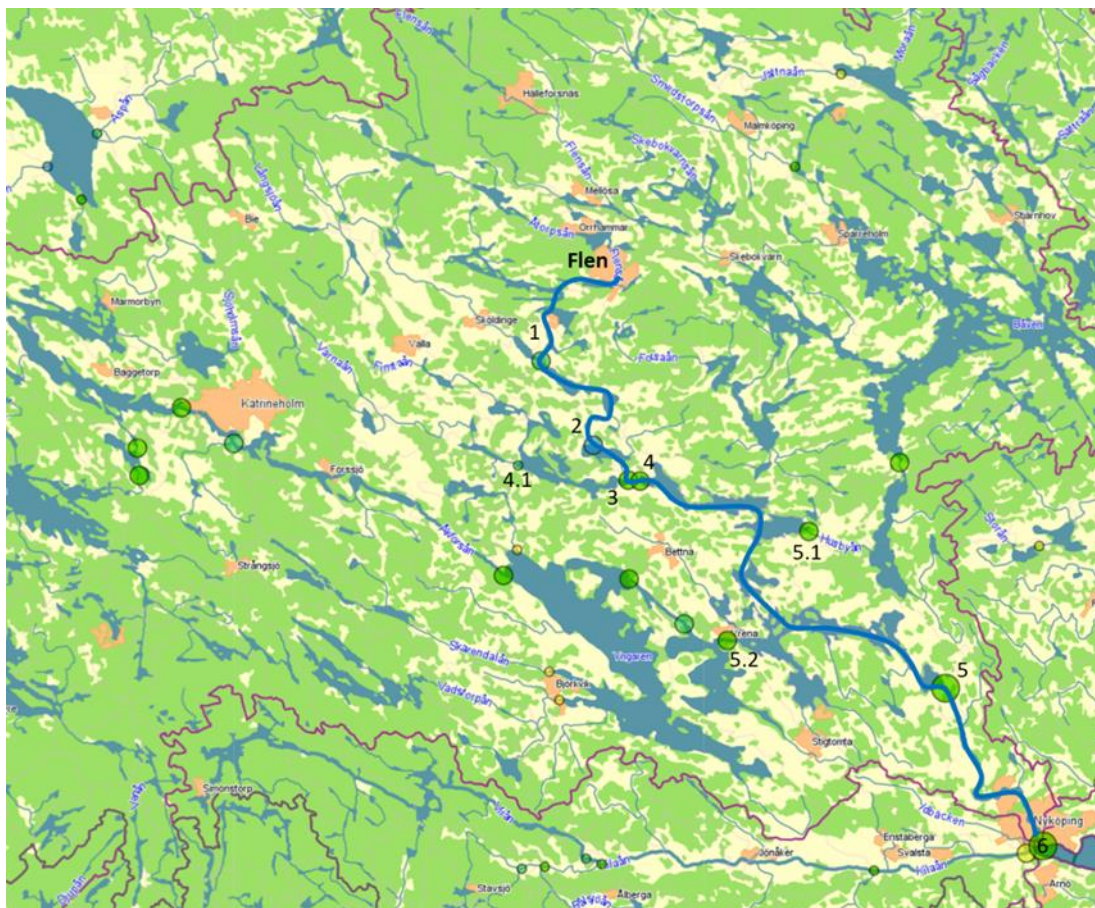
Figur 2. Flens avloppsreningsverk och rinnsträckan till havet (blå linje) som passerar sex mätstationer (cirklar numrerade 1-6) och biflöden med mätstationer (cirklar numrerade 4.1, 5.1 och 5.2).
